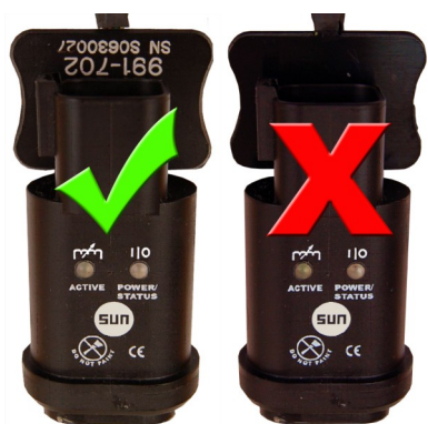
图 18. 嵌入式放大器正确和错误的IR适配器安装方位
