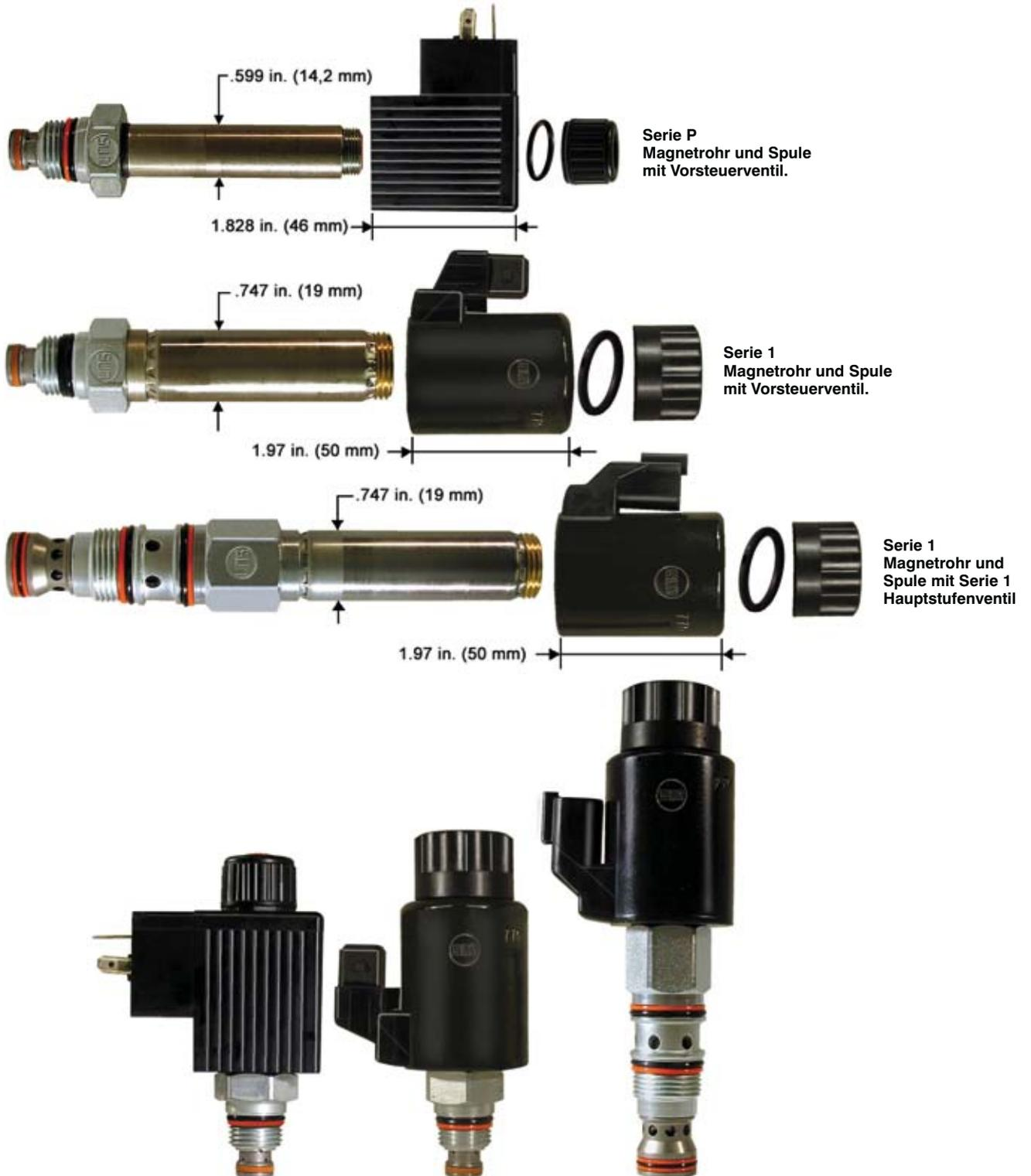
**Bild 1:** Gezeigt ist ein Vorsteuerventil mit Serie P Spule und Serie 1 Spule sowie ein Hauptstufenventil mit Serie 1 Spule, jeweils zerlegt und komplett montiert.
