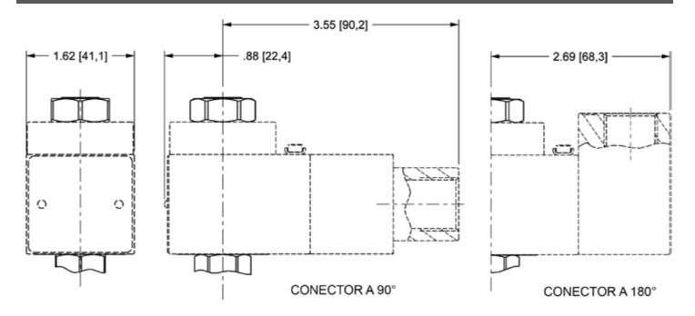
NOTA: Verifique los requisitos de tolerancia del cartucho al elegir un bloque SUN. Los diferentes comandos de válvulas y bobinas requieren diferentes holguras. Un adicional de 50,8 mm (2,00 pulgadas) más allá de la extensión de la válvula es necesaria para la instalación y extracción de la bobina.
