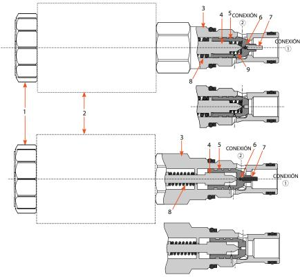
Las válvulas proporcionales de asiento 2/2 vías son operadas por piloto. Ellas comprenden un cuerpo hexagonal con asiento de válvula (3), solenoide con bobina (2), válvula de asiento (5), vástago (4), tuerca de bobina (1), bola (6), pasador (7) y dos resortes (8 y 9) para FPBG y FPBF, y un resorte (8) para FPBJ y FPBI.
