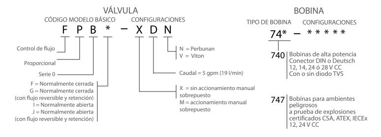
Consulte las hojas de datos individuales de la bobina para conocer la configuración completa de la bobina.
